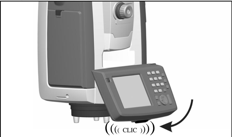
Figura 4.40 Conexión del Trimble CU
