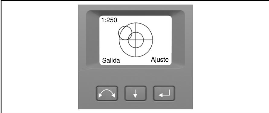
Figura 3.18 Pantalla de nivelación electrónica en la pantalla del círculo inverso
