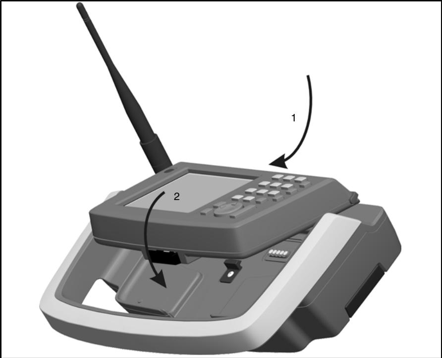
Figura 7.73 Conexión del Trimble CU al soporte robótico de Trimble
