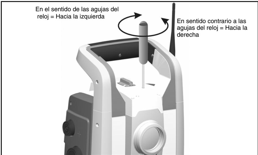
Figura 4.35 Ajuste de la posición horizontal
