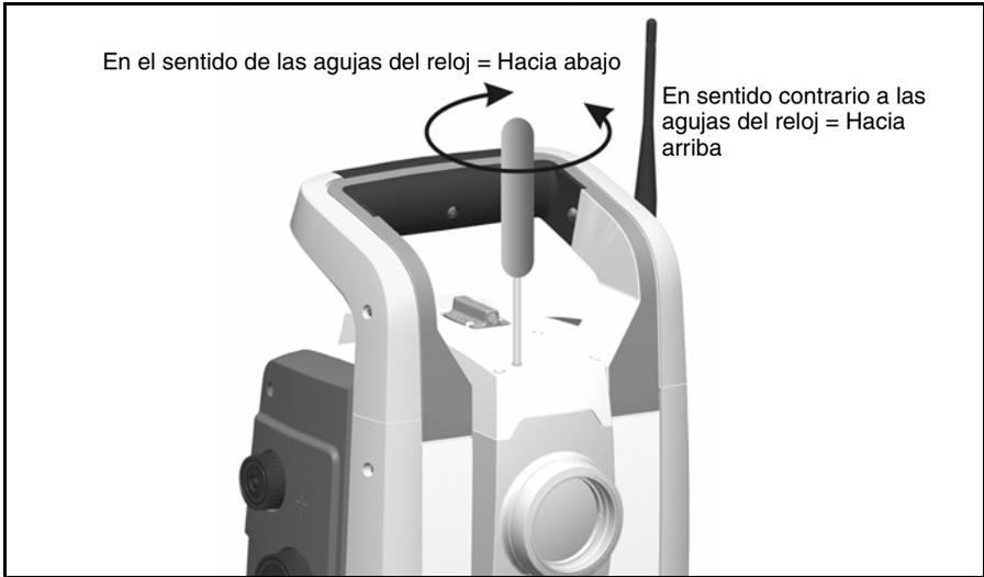
Figura 4.34 Ajuste de la posición vertical
