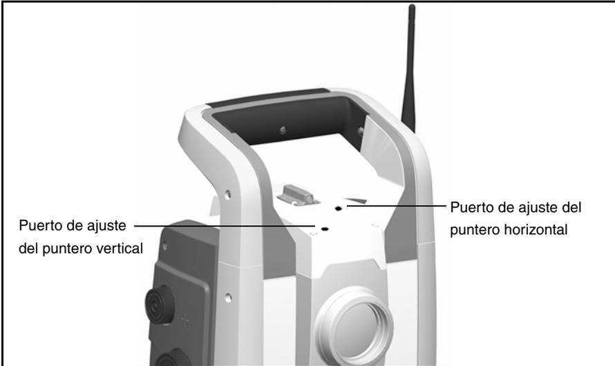
Figura 4.33 Puertos de ajuste del puntero láser
