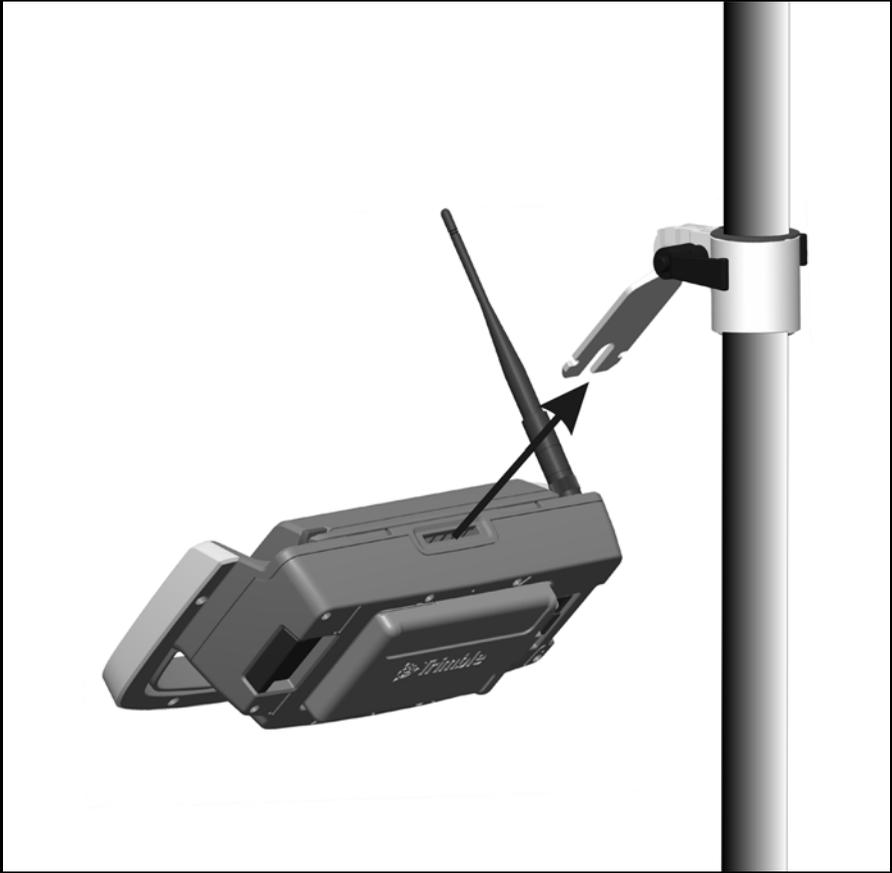
Figura 7.75 Conexión del soporte robótico de Trimble al adaptador del jalón estándar
